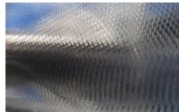
Hình 1. Độ nhám bề mặt khi xảy ra dao động tự kích
