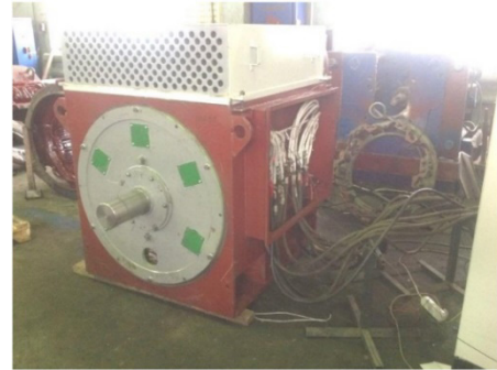
Hình 9. Hình dạng bên ngoài của SRM-750 với bộ làm mát dạng ống
