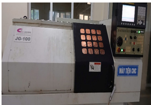
Hình 1. Máy tiện CNC băng nghiêng JG-100
