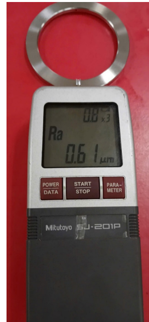
Hình 6. Đo độ nhám bề mặt gia công (mặt A) tại thí nghiệm 23
