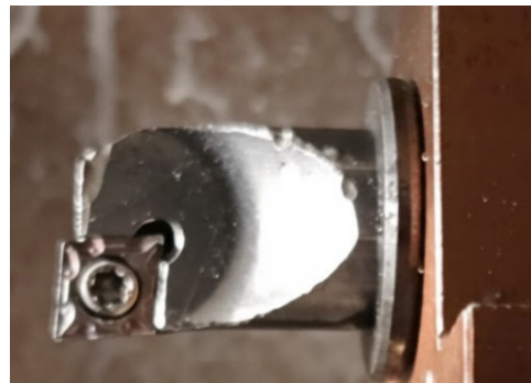
Hình 2. Dao tiện gắn mảnh chip CNMG 120408
